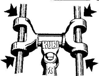
Si el polvo acumulado impide un buen deslizamiento, engrase las partes señaladas con aceite lubricante. Secar bien el aceite de las guías si continuamos haciendo polvo.
