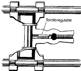
Para una mejor protección de los útiles de corte, su cortador está provisto de un mecanismo de retención interno que evita la caída del mango. Este mecanismo es fácilmente reajustable con un destornillador.
