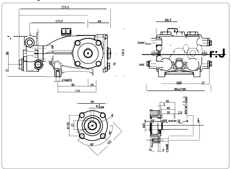
Lubrificazione : Olio SAE 20/40W Capacita 0.7 litri Lubrica tion: SAE 20/40W Oil Capacity 0.7 liters
